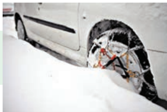
شکل ۸-۲۳ - استفاده از زنجیر چرخ
