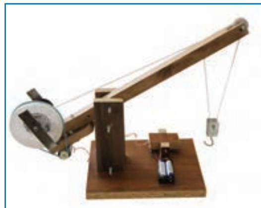
الف- ساز و کار حرکتی جرتقیل اسباب بازی
