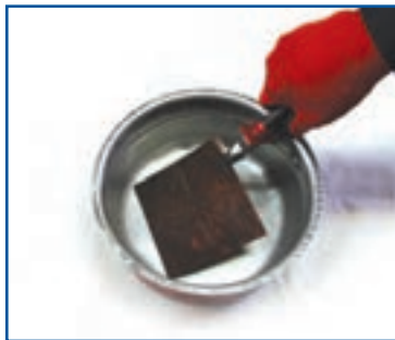
شکل ۹-۱- سرد کردن پلاک مسی با آب
