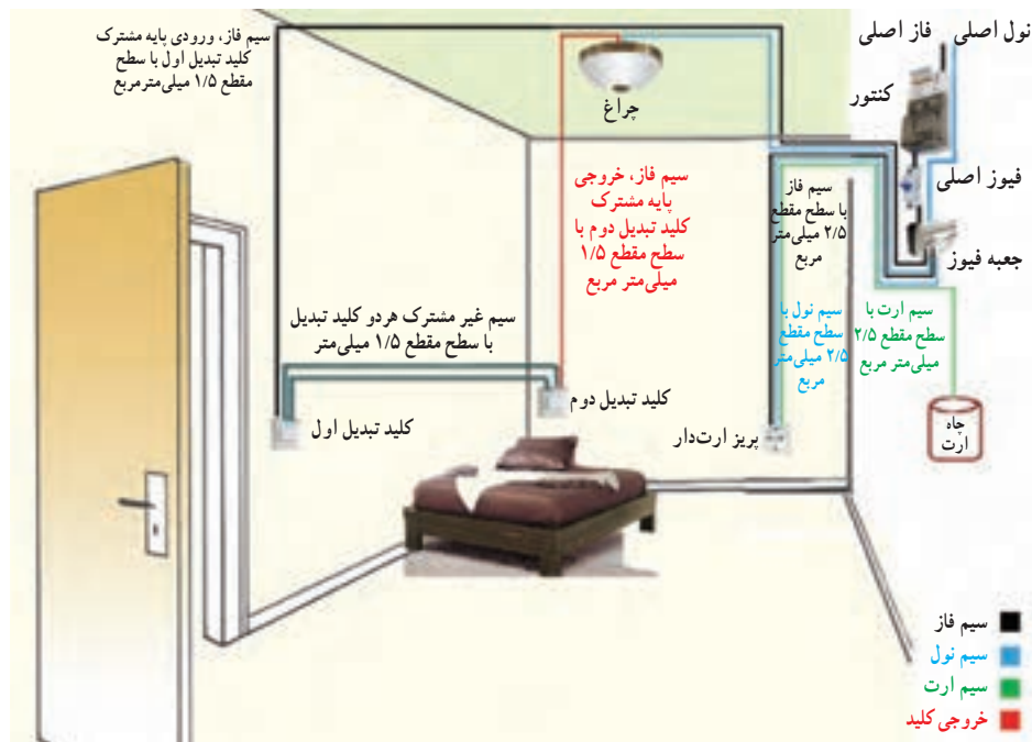
شکل ۱۸-۵- سیم‌کشی مدار کلید تبدیل
